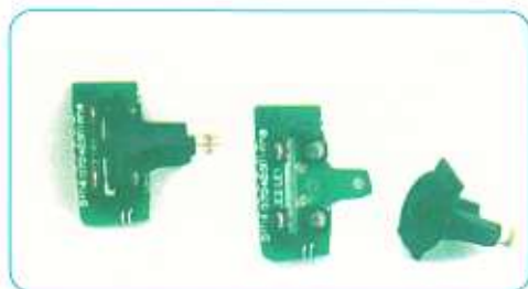
Links: de encoder compleet. Midden: de LEDs en de fototransistoren zijn duidelijk zichtbaar nadat de sleuven-schijf (rechts) is afgeklikt.
